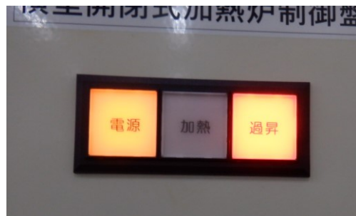
過昇防止稼働時 過昇点灯、加熱切断
